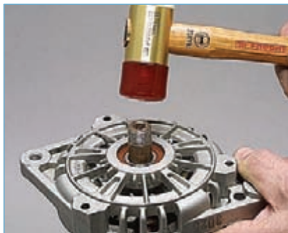
Молотком с пластмассовым бойком выбиваем вал ротора из подшипника.
