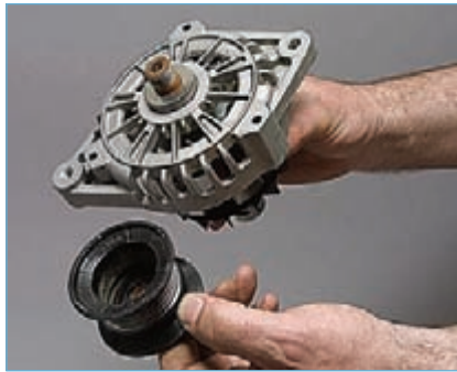
Снимаем с вала ротора шкив...
