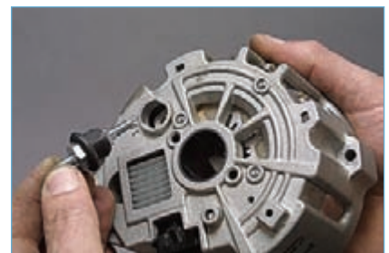
...и вынимаем контактный болт.
