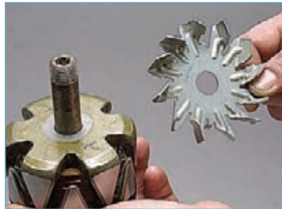
...и крыльчатку вентилятора. Отверткой разгибаем концы выводов выпрямительного блока...
