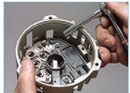
Головкой «на 8» с удлинителем отворачиваем гайку крепления вывода клеммы «ВАТ» (контактного болта)...
