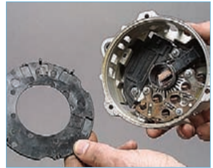
...и снимаем пластмассовую отражательную шайбу.
