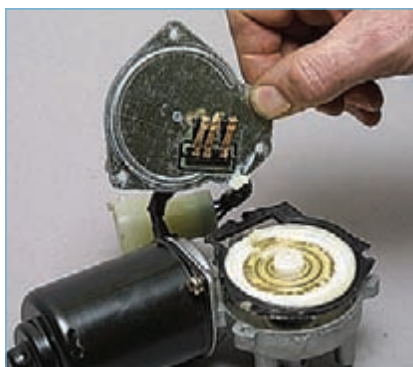
...и, отсоединив крышку, отводим ее в сторону.
