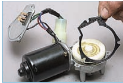
Сняв уплотнительную прокладку с корпуса...
