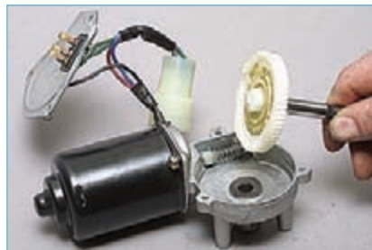
...извлекаем из него шестерню моторедуктора с валом.
