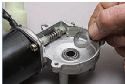
Снимаем опорную пружинную шайбу шестерни.
