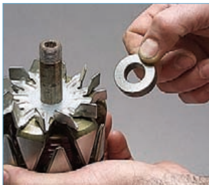
Снимаем с вала ротора распорную втулку...
