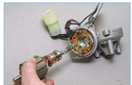
Устанавливаем якорь в корпус моторедуктора...
