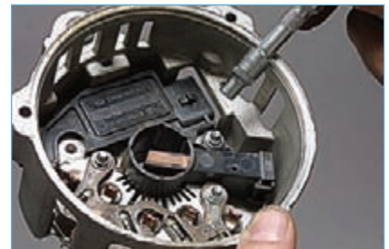
Головкой «Е6» с удлинителем отворачиваем четыре винта крепления выпрямительного блока и щеткодержателя с регулятором напряжения...
