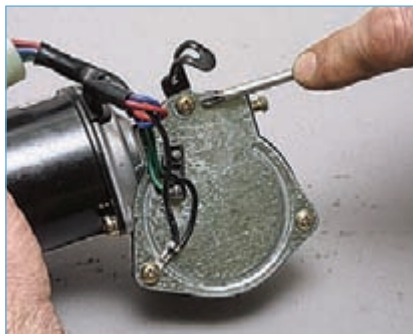
Крестообразной отверткой отворачиваем три самореза крепления крышки к корпусу моторедуктора...
