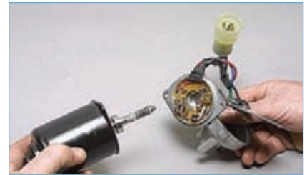
...и аккуратно, стараясь не повредить щетки, снимаем крышку вместе с якорем.
