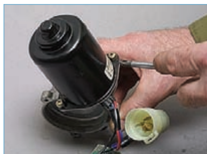
...крестообразной отверткой отворачиваем два винта крепления крышки электродвигателя к фланцу корпуса моторедуктора...
