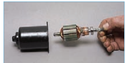
Извлекаем из крышки якорь, преодолевая притяжение двух постоянных магнитов.
